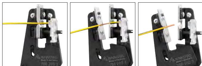
Kabel an Längenanschlag anlegen Position cable at length stop
