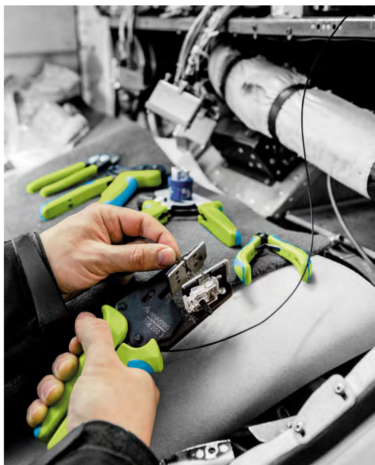
Automatisches Abziehen der Isolation Automatic removal of insulation
